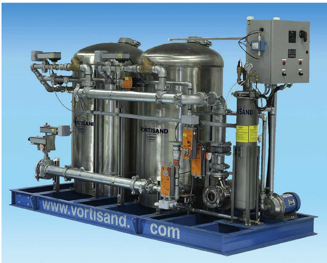
Le système de filtration automatique de l'eau Vortisand, monté sur skid, associe la séparation centrifuge et la filtration sur sable, ce qui permet d'économiser l'eau de lavage / The water automated filtration system Vortisand, mounted on skid, associates a centrifugal separation to a sand filtration, which generates large savings on cleaning water (doc. SONITEC).
